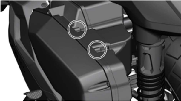
4. ถอดสกรู 5 ตัว สำหรับการถอดเปลี่ยนไส้กรองไอต์เครื่องยนต์
