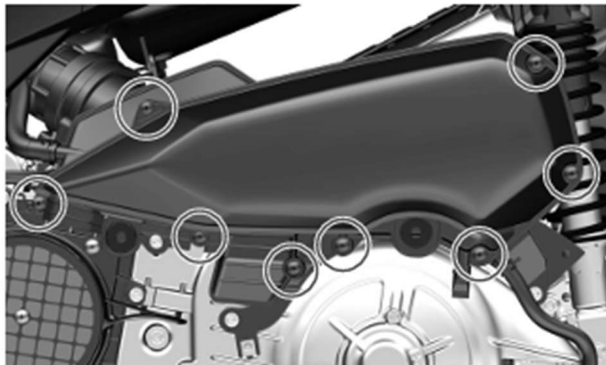
5. ถอดสกรู 10 ตัว เพื่อถอดกรองอากาศด้วยภาพ
