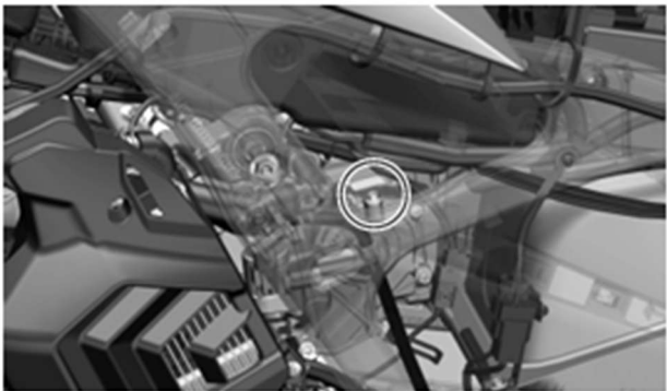
(2) ถังระบายน้ำ
